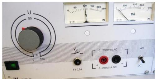
Рис. 5. Источник тока для нагревания излучателя.
